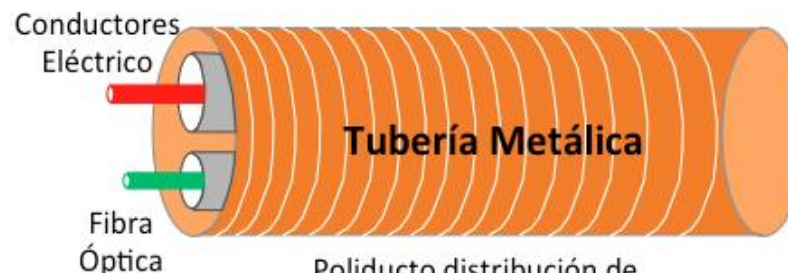
Poliducto distribución de Energía Eléctrica y Fibra Óptica
